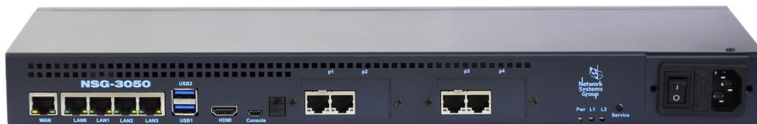
Устройство имеет 1 выделенный порт WAN и 4 порта LAN, объединённых коммутатором. Суммарная пропускная способность портов LAN для трафика L3 или коммутации L2 с остальными портами — 1 Мбит/с. Коммутация L2 между портами LAN, осуществляемая в терминах *bridge groups*, производится без ограничения, т.е. на максимальной физической скорости линии.
