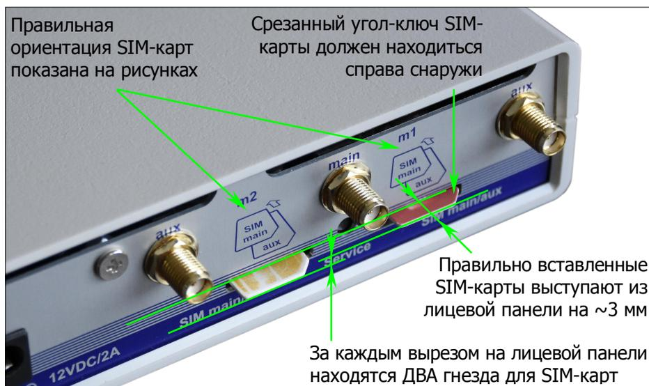
**ВНИМАНИЕ!** Некоторые модели имеют ДВА гнезда для SIM-карт щелевого типа, расположенные за одним вырезом лицевой панели. При установке необходимо внимательно следить за тем, в какое из двух гнёзд устанавливается карта.
